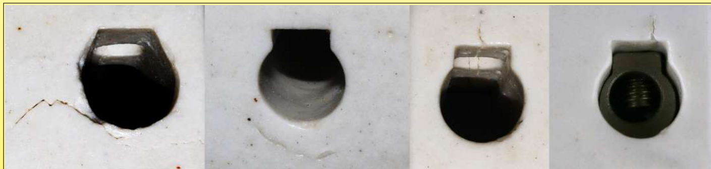
C111陶瓷的裂痕示例
